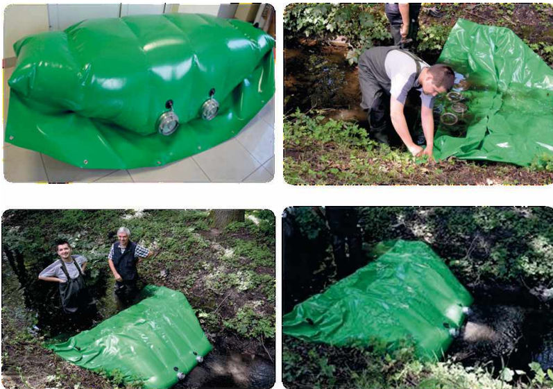
Fot. 17. Wielofunkcyjny przenośny próg piętrzący (fot. K. Krężałek; źródło: www.itp.edu.pl )
